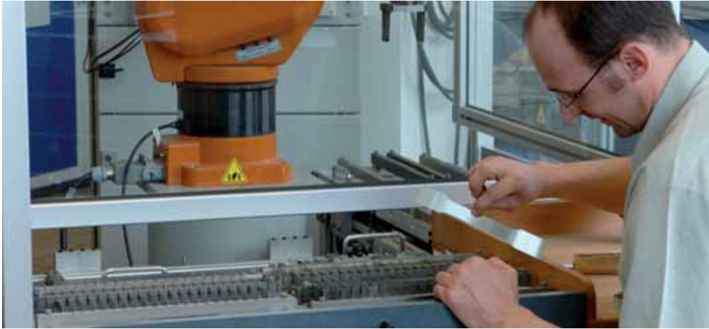
Festigkeitsbestimmung von Blechen an einer Zugprüfmaschine
